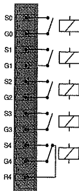
Рис. 377 – Свързване конекторите на цифровите изходи
