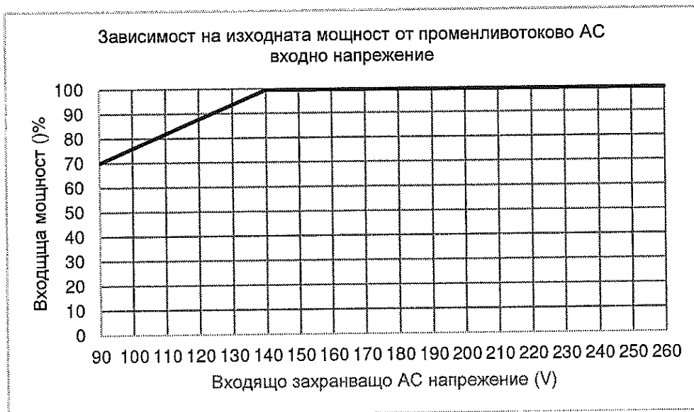
Рис. 12 - Зависимост на мощността от входящото захранващо напрежение (за захранващ източник 230 V)
